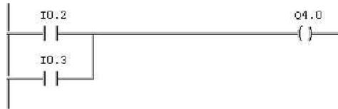
Figure 12: Kontaktplan OR-Verknüpfung
