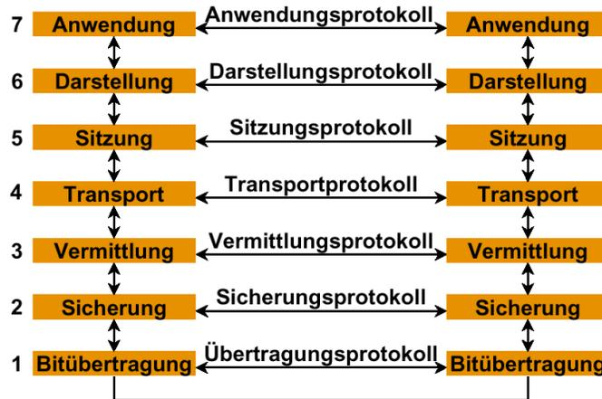
Figure 8: OSI Schichtenmodell
